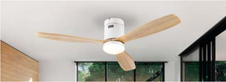
329576 LED 15W / 1.200 lumen / CCT 3.000 - 4.000 - 5.000 K Motor / motor fan DC 22W Hélice de 3 aspas / 3-blade fan Ø132 cm 6 velocidades / 6-speed (100/120/140/160/180/200 rpm), reversible / reverse Emisión de ruido: máxima 50 db / Noise emission: maximum 50 db
